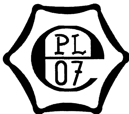
Rysunek 3. Wzór cechy legalizacji, która może być umieszczana na materialnych miarach długości
